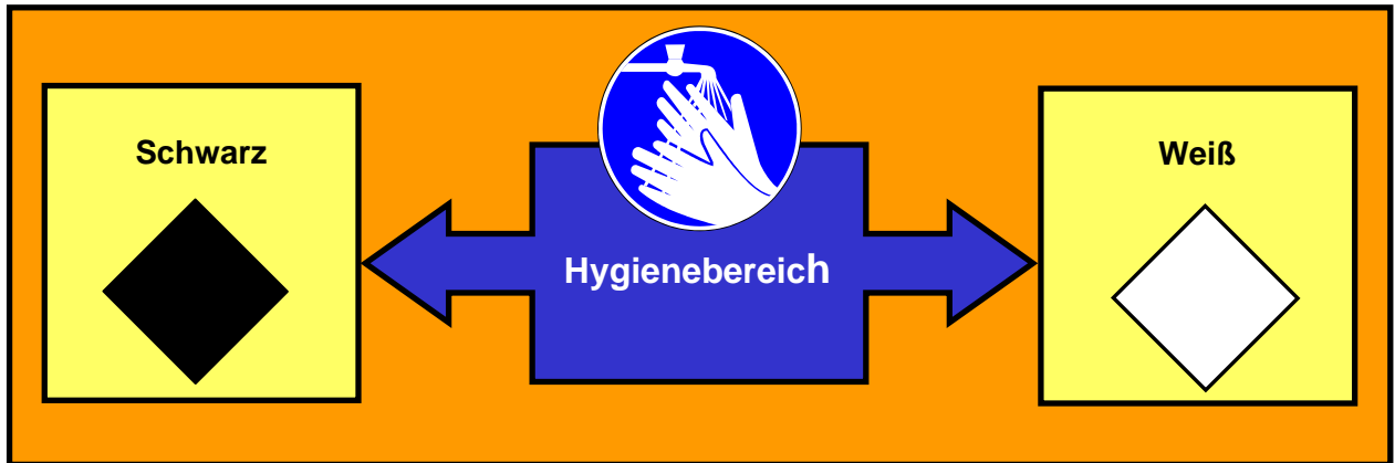
Bild 3: Grundkonzept einer SW-Anlage
