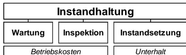
Bild 1: Struktur der Instandhaltung nach DIN 31051
